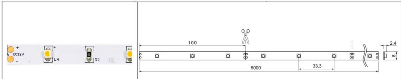
Flexible LED-Leiterplatte mit SMD-3528-LED (PLCC2), 5000mm lang, rückseitig 3M-Klebeband, Aderenden verzinkt, 350mm Anschlussleitung
