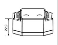
DALI Taster-Modul mit 4 Eingängen für konventionelle Lichttaster, zur Steuerung von 4 DALI-Adressen (Leuchten), Montage in Schalterdose
