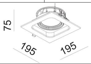
Deckeneinbauleuchte, schwenkbar, inkl. Zugentlastung und Fassung recessed ceiling downlight, adjustable, incl. strain-relief and socket
