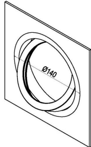
Deckeneinbauleuchte, schwenkbar, inkl. Zugentlastung
